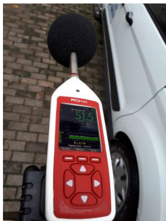
Тестирање на ниво на бучава во животната средина од котларницата за загревање на управната зграда на Макпетрол АД
